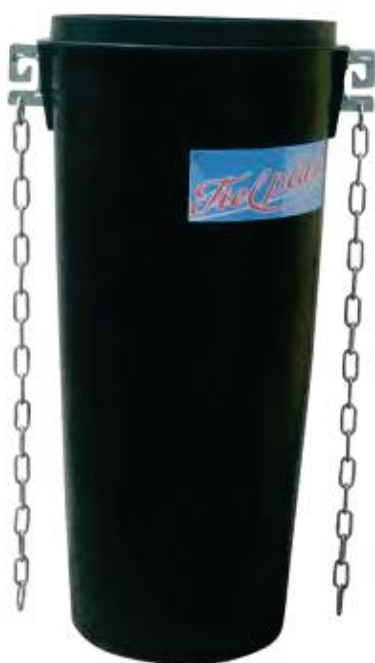
Bajante tramo recto Plastic straight section Cadena DIN 763 Ø 6 mm. Alto 1.10 m espesor 6 mm
